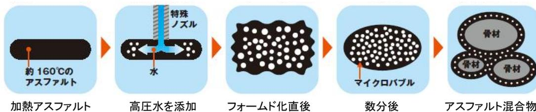
図-1. マイクロバブル型フォームドアスファルト混合物の製造概念図
