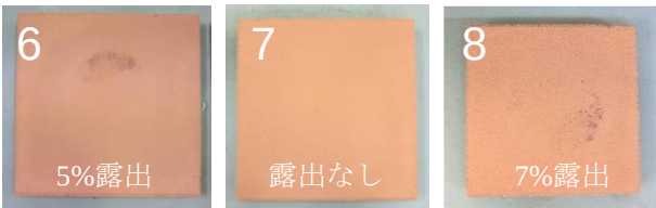
写真-3 摩耗試験後の供試体 6～8
