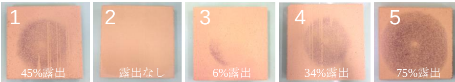
写真-2 摩耗試験後の供試体 1～5
