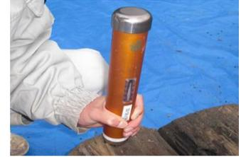
写真-2 ピロディン試験実施状況
