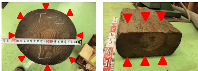
図.2 打ち込み試験の実施位置(▲は試験位置)
