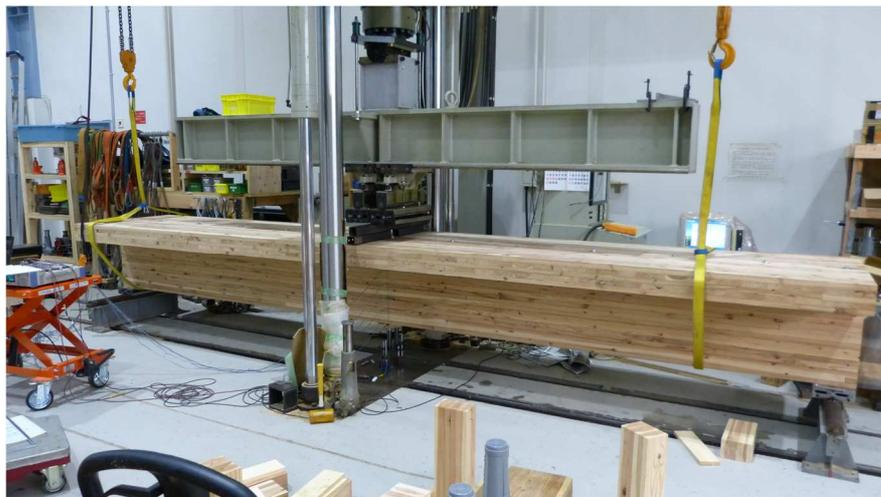
写真1 T型梁による曲げ試験
