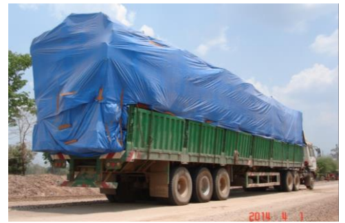
写真 2 総重量 120 t の材木運搬車
