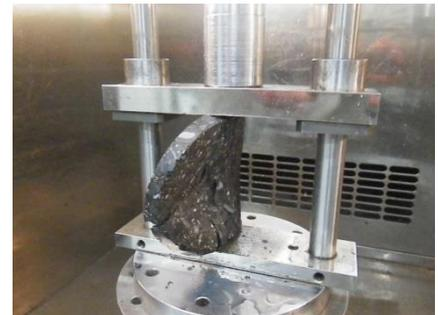
写真-1 圧裂試験状況 (厚さ10mm)
