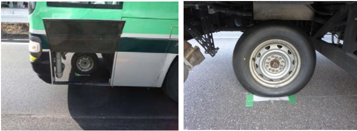
(すべり測定車第 5 輪) (測定風景近接) 写真-1 タイヤ／路面接地応力分布の測定
