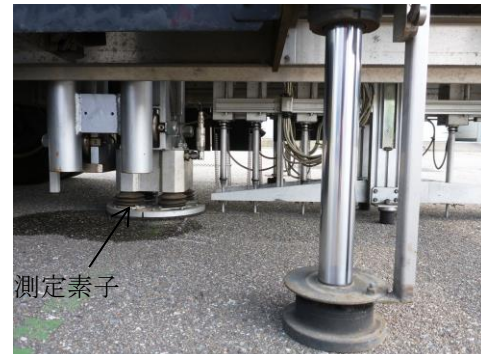
写真-3 載荷部のセンサーの測定素子
