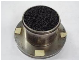
写真-4 上端面成形完了
