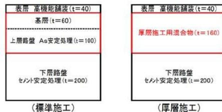
図-1 標準施工と厚層施工の舗装構成例
