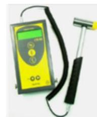
写真-1 シルバーシュミット 写真-2 コンクリートテスター
