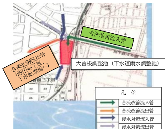
図4 駅前広場地下の雨水調整池（大曽根駅）
