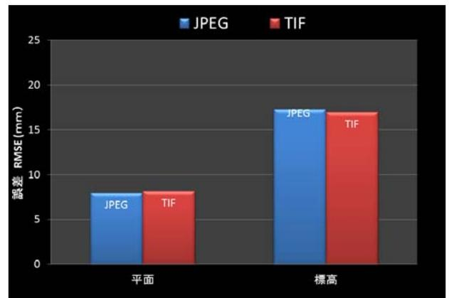
図-5 写真ファイル形式の精度比較 (h60m)
