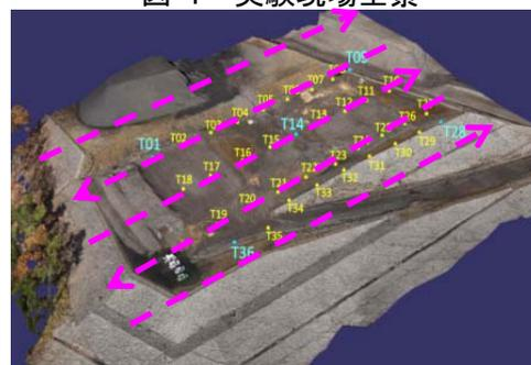
図-2 飛行コースと検証点の配置
