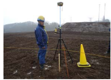
写真 - 3 GNSS 受信機調査状況
