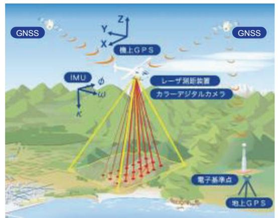
図-1 航空レーザ計測の概要
