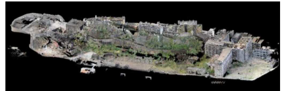
図1 軍艦島のレーザデータ(3D点群モデル) 1)
