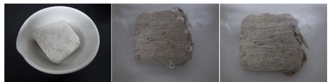
図 6 堆積軟岩 C のスレーキングによる形状変化
