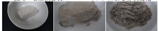
図 5 堆積軟岩 B のスレーキングによる形状変化
