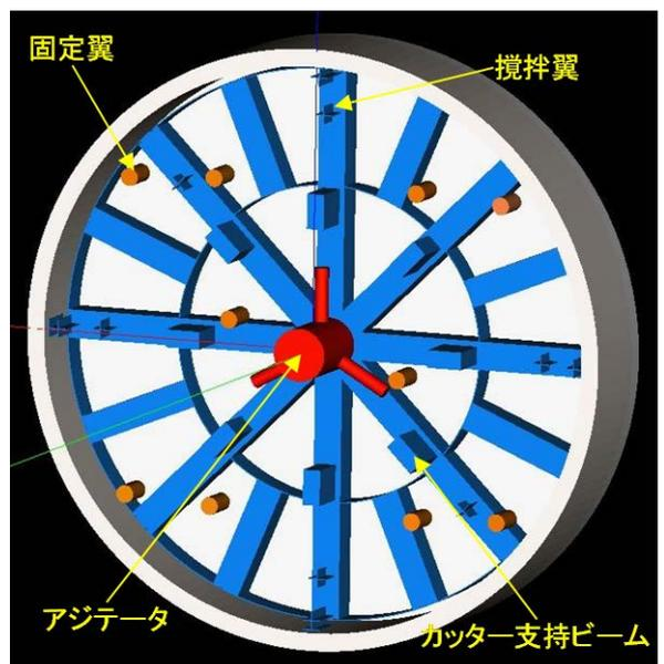
図-2 解析モデル (坑内側より)
