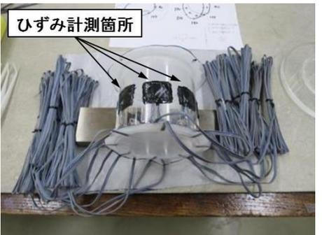
写真2 断面力計測用模型
