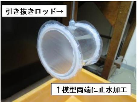
写真1 トンネル模型引き抜き装置
