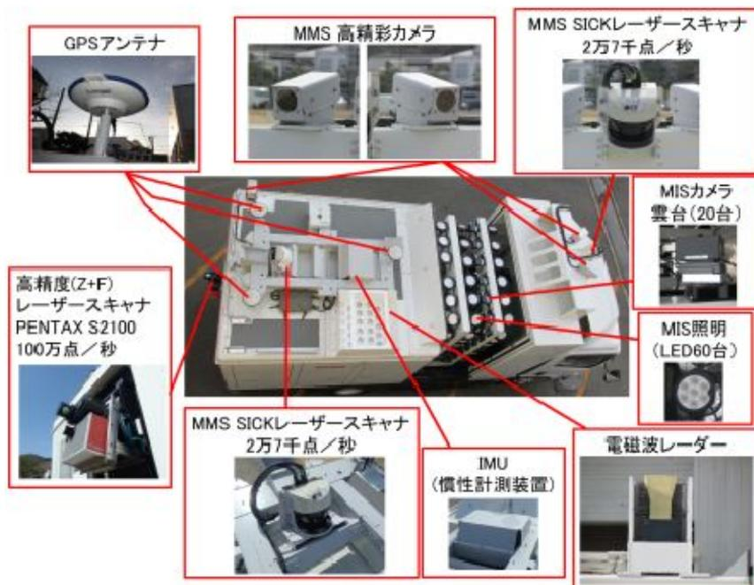
図-1 走行型計測システムの概要 (MIMM-R)
