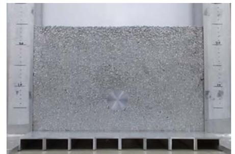
図 2-1 埋設（円形断面, 土被り 3D）
