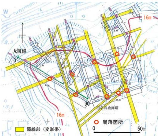
図-5 変形帯分布と崩落箇所位置図
