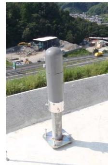
写真-1 傾斜計固定状況
