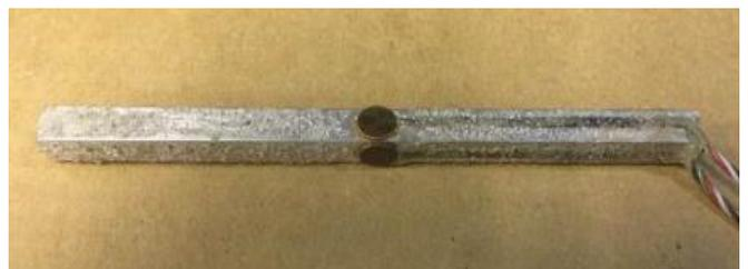
写真1 角棒型土圧センサー
