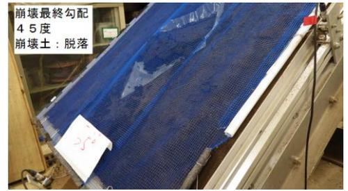
写真-4 試験状況(アンカーなし)
