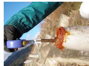
写真-2 より線の飛出し
