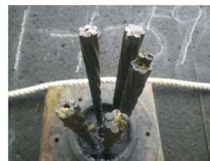
写真-5 より線の飛出・引込み
