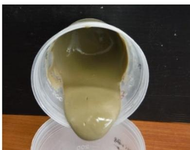
写真2 開発中の裏込材が流動する様子(-10℃)
