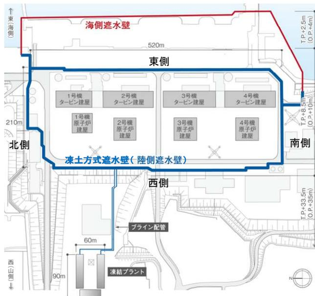
図-1 凍土方式遮水壁の配置 (平面図)
