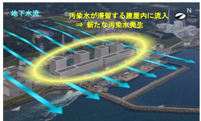
図-1 建屋周りの地下水の流れ
