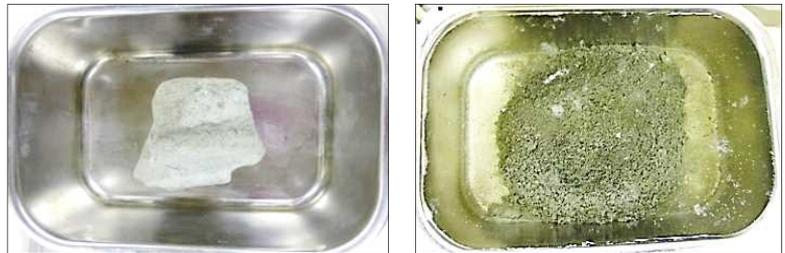
(a) 水浸前(炉乾燥後) (b) 水浸 30 分後
