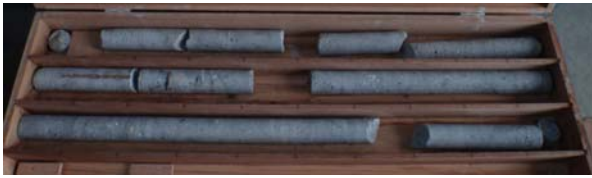
写真-2 改良体確認 (コア採取状況)
