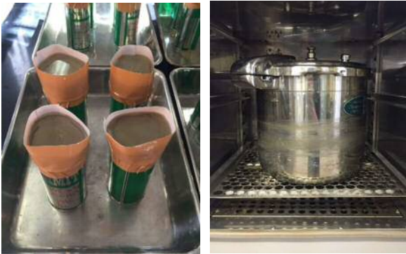
図-2 作製したソイルセメント試料と促進養生装置
