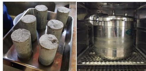
図-1 作製した供試体と促進養生装置
