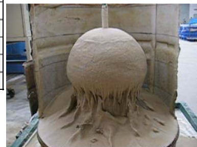
写真-1 模型実験による改良体出来形 2)
