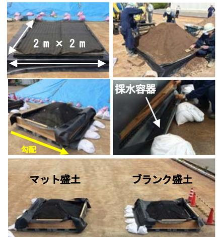
図5 盛土曝露試験の状況
