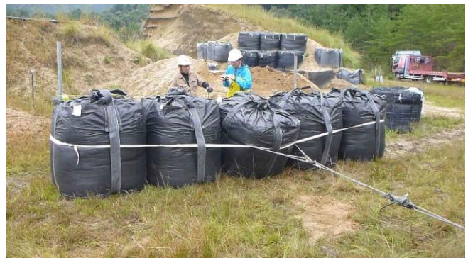
写真-1 変位 50 cmの状況(左:連続箱型鋼製枠, 右:耐候性大型土のう(結束有))
