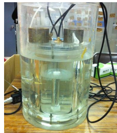
写真-3 試験時 簡易恒温槽内部状況
