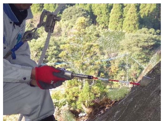
写真 1 土壌硬度計測状況
