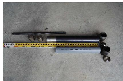
写真 1 特製打ち込み式サンプラー
