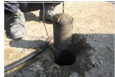
図-4 土壤水分計を埋め込んだ供試体
