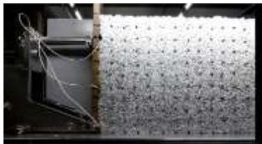
図-2 変形前の擁壁とアルミ棒積層体
