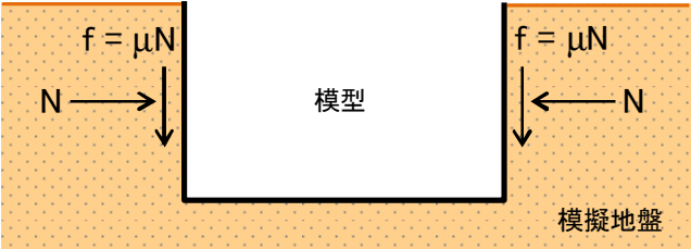
図-6 模型底面部の土圧挙動
