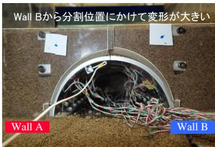
写真 2 加振後の模型の状態
