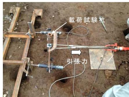
写真1 単杭の水平載荷状況
