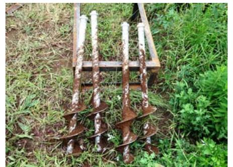
写真3 組杭試験後に撤去した杭
