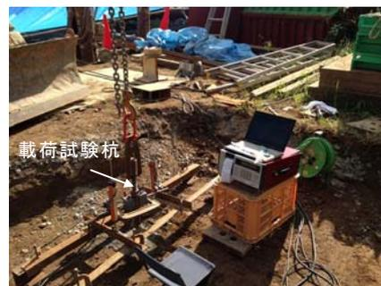
写真3 引抜き試験状況
