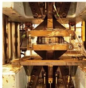
写真4 引張試験の状況
