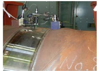
写真2 鋼管の局部変形
