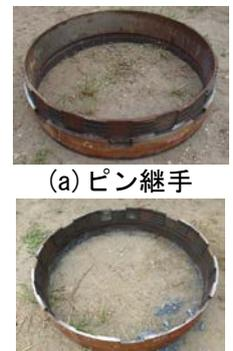
写真 3 施工後の継手 (打撃工法)
