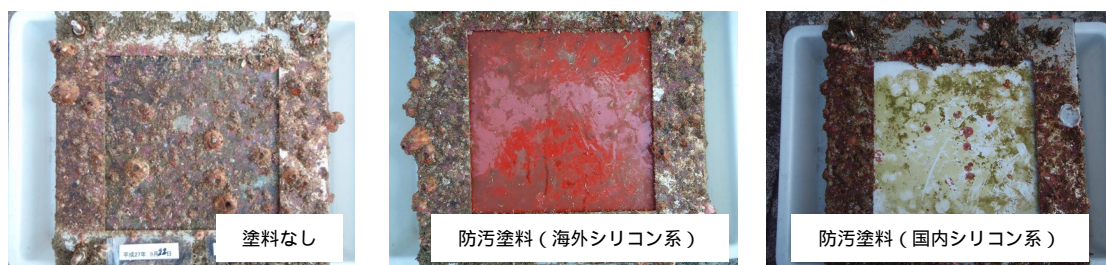
図-4 生物付着状況（ブレード）
