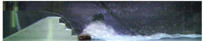
写真-1 蛇籠設置数1個, 粒径小, 流量小の流況
